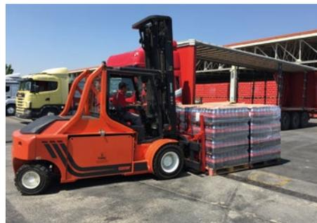
hohe Effizienz gewährleistet und einen geräuscharmen Betrieb, durch die hohe Präzision der Schrägverzahnung erreicht. Die Hinterachse verfügt über einen Lenksensor, der die Reduzierung der Geschwindigkeit bei Kurvenfahrten garantiert.
