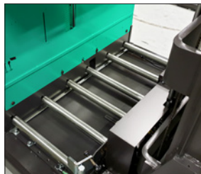
Batterie auf Stahlrollen
