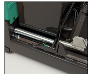
Batterie auf Rollen
